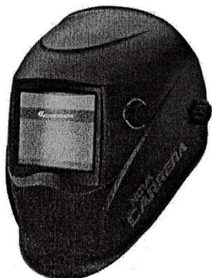
Indicada para proteger os olhos e face do soldador contra radiação, faíscas e respingos provenientes do processo de solda por arco elétrico e corte no processo de arco-ar. Não atende aos processos de corte a laser, plasma e solda/corte oxicomustível.
